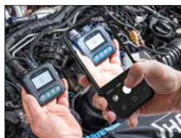
Erzeugung von QR-Codes zum Teilen der Testergebnisse auf Smartphone / Tablet
