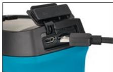
Stromversorgung: USB Kabel (Micro USB)
