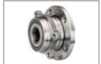
4 Bolzen geteilte und verschraubte Radlagereinheit
