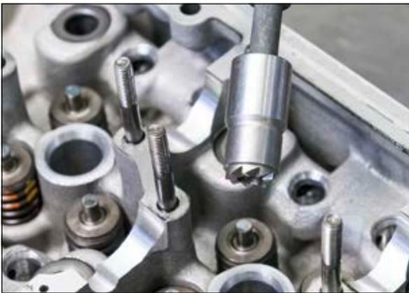
**Fachgerechtes Reinigen des Injektorschachtes, der Injektorspitze und Düsenzapfenöffnung**
